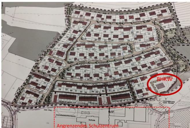
Das Wärme-Versorgungsnetz liegt an sämtlichen 115 Parzellen im Wohngebiet an. Bis dato wurden 77 Häuser im Wohngebiet an das Wärmenetz angeschlossen (Übergabestellen).
